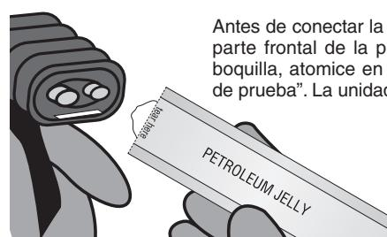
Antes de conectar la boquilla, coloque vaselina en la parte frontal de la pistola. Después de conectar la boquilla, atomice en un receptáculo una "aplicación de prueba". La unidad está lista para usar.
