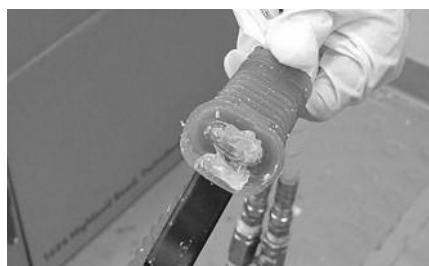
**¡Cambio las boquillas con frecuencia!** La espuma curará dentro de la boquilla en el mismo lapso de tiempo en que la espuma deja de ser pegajosa al aire.
